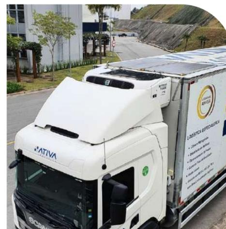
Em nossa frota, possuímos caminhões com placas solares acopladas na parte externa do teto do baú, visando economia de combustível, menor emissão de CO<sub>2</sub> e autonomia elétrica.
